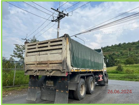
ภาพที่ 2-9 การปิดคลุมผ้าใบของรถบรรทุก
