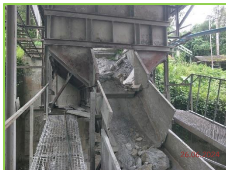
ภาพที่ 2-13 การปิดคลุมบริเวณยังรับแร่
